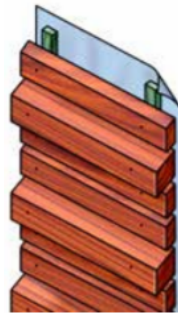
Abbildung 3 - Horizontale offene Fassadenverkleidung mit verschiedenen Abmessungen, abgechrägt für eine gute Entwässerung. (Quelle: Centrum Hout, 2018)
