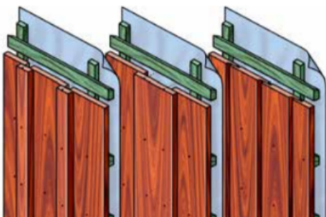
Abbildung 2 - Horizontale Fassadenverkleidung V.l.n.r. Stülpschalung, Keilstülpschalung, Keilstülpschalung und Wechselfalzschalung. (Quelle: Centrum Hout, 2018)
