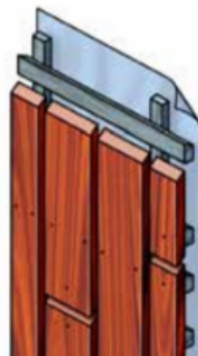
Abbildung 5 - Vertikale offene Fassadenverkleidung (Quelle: Centrum Hout, 2018)
